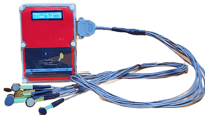
شکل ۲: دستگاه سنجش فشار تماسی (ErgoFs16)
