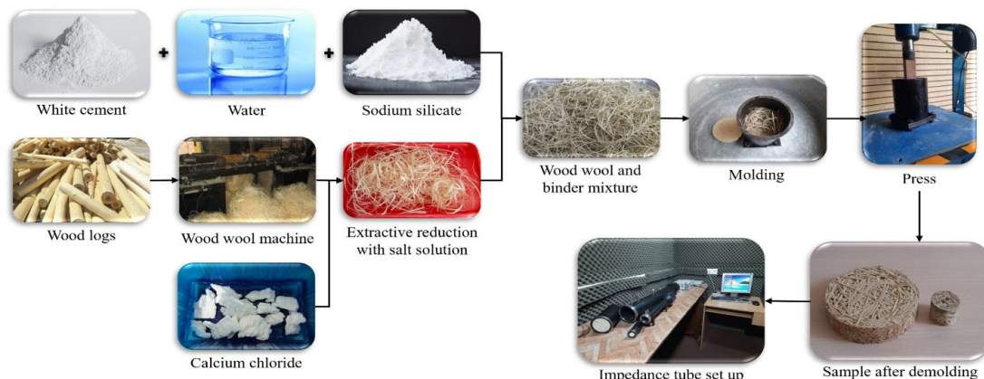
شکل ۱: فلوچارت ساخت نمونه‌ها و اندازه‌گیری ضریب جذب
