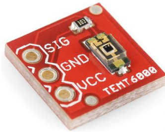
شکل ۴: تصویر سنسور سنجش روشنایی
