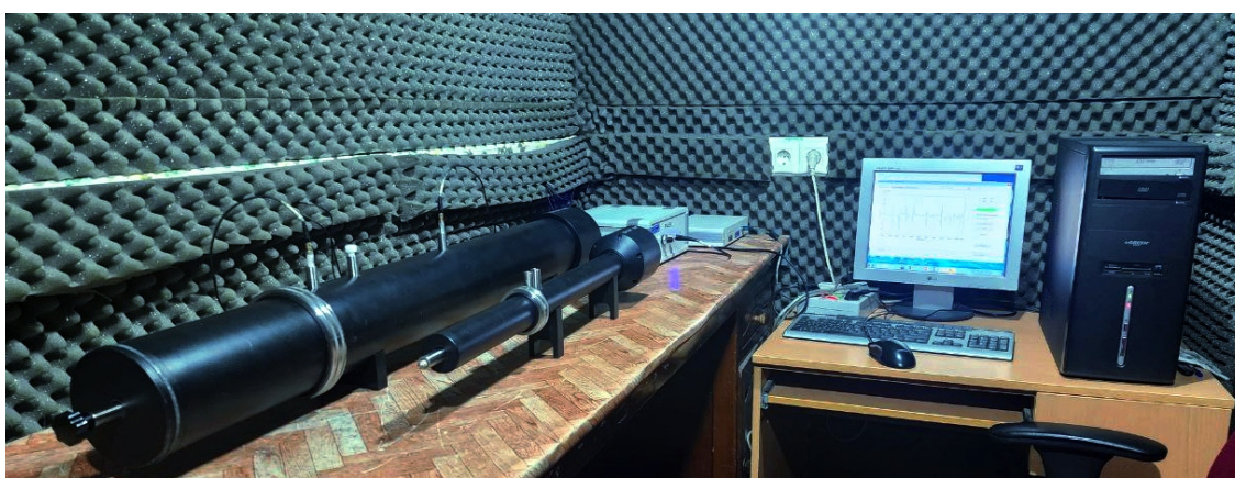
شکل ۲: مجموعه امپدانس تیوب ۲ میکروفون استفاده شده در مطالعه
