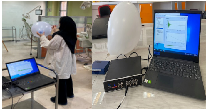
شکل ۱: ست دستگاه آنالیزور آکوستیکی مورد استفاده و نمونه ای از انجام تست زمان بازآوایی
