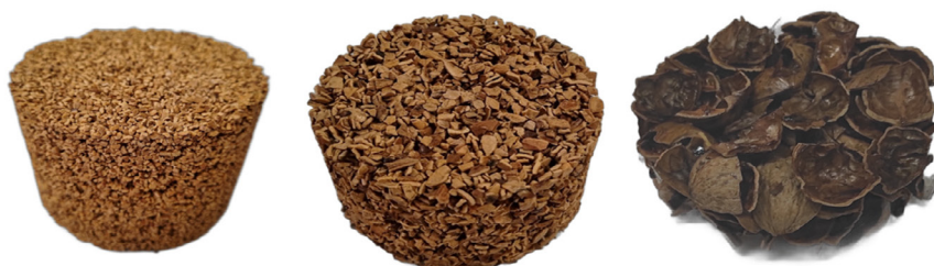
شکل ۱: نمونه‌های ساخته شده از پوست سخت گردو در سه حالت خردایش کم (راست) متوسط (وسط) و زیاد (سمت چپ) به عنوان جاذب صوت
