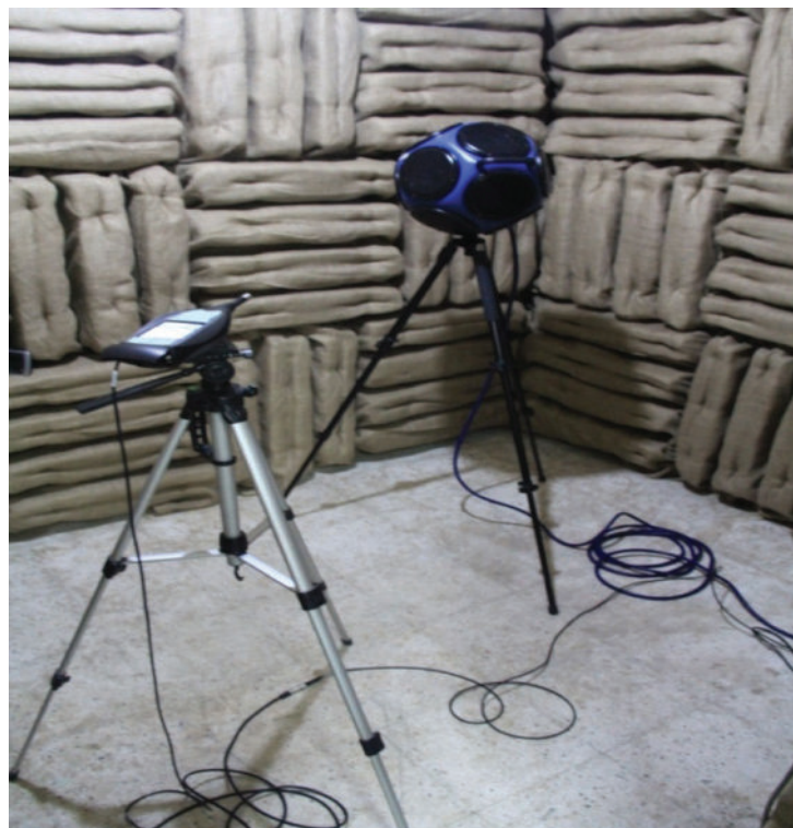
شکل ۱: ست اندازه‌گیری زمان بازآوایی به روش صدای منقطع
