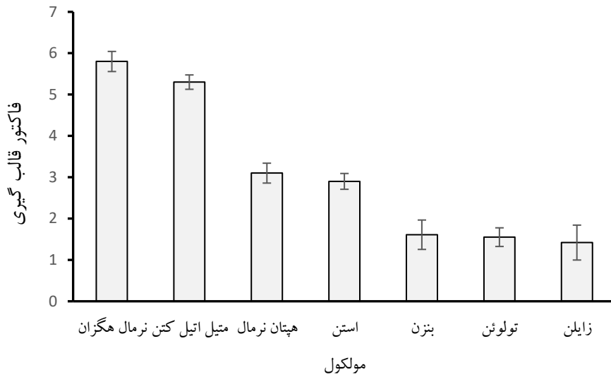
شکل ۴: فاکتور قالب‌گیری MIP در روش ابزار تله سوزنی
