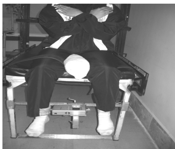
شکل ۳- تست قدرت عضلات روتاتور خارجی ران با استفاده از دینامومتر ثابت شده با چهار چوب فلزی
