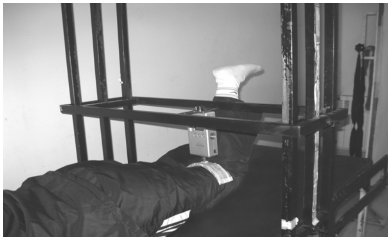
شکل ۱- تست قدرت عضلات اکستانسور ران با استفاده از دینامومتر ثابت شده با چهارچوب فلزی
