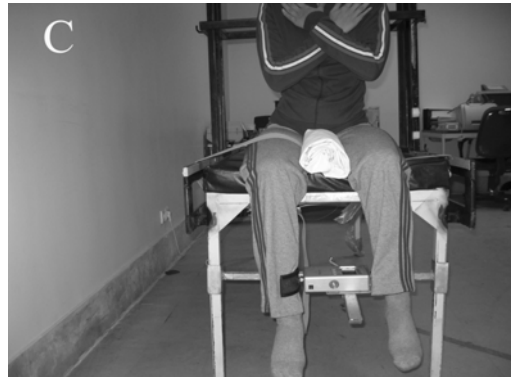
شکل ۱- تست قدرت عضلات باز کننده (A)، دور کننده (B) و چرخاننده خارجی ران (C) با استفاده از دینامومتر ثابت شده با چهار چوب فلزی
