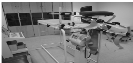
شکل 1- چیدمان ساخته شده مورد استفاده جهت اندازه‌گیری سفتی عضلانی
