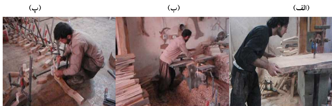
شکل ۱- وضعیت های بدنی نامطلوب کارگران کارگاه تهیه مبلمان خام در انجام وظایف الف) برش چوب با دستگاه اره فلکه، ب) رنده با دستگاه سه کاره و پ) بستن قطعات با پیچ گوشتی.
