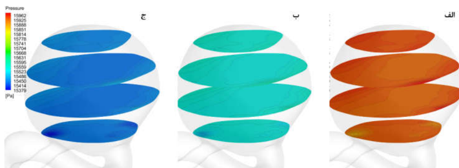
شکل ۳: توزیع فشار در چهار صفحه موازی درون آنوریسم در سیال الف) پاورلا، ب) کارو و ج) نیوتنی
