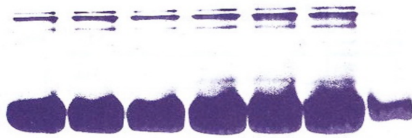
شکل-۲: الکتروفورز SDS-PAGE آلبومین تهیه شده در مقایسه با آلبومین های خارجی
