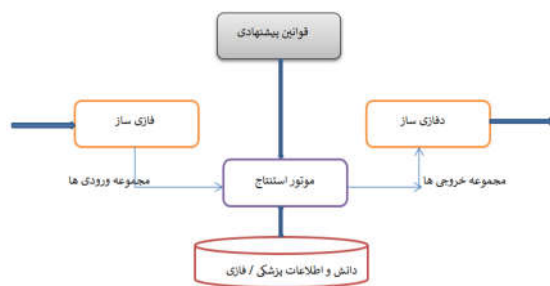
شکل ۱: ساختار سیستم فازی
